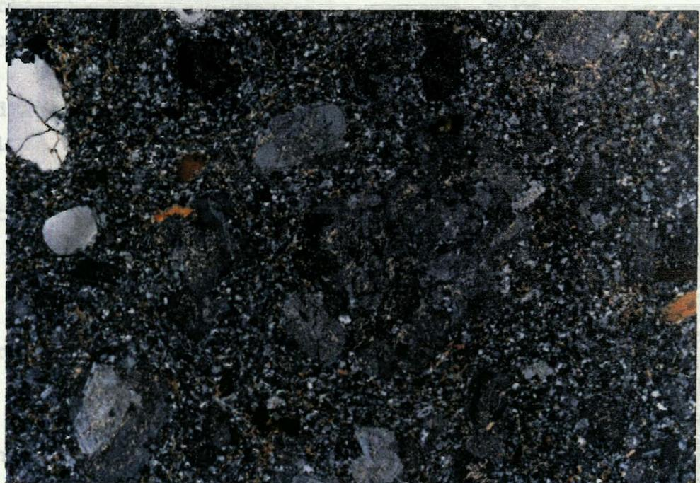
Abb.39: Granodioritporphyr: Die Probe Al/D-5 stammt vom Nordufer des Lateinbachtals 150 m östlich der Kote 292; Bildausschnitt: 10,0 x 6,5 mm.
