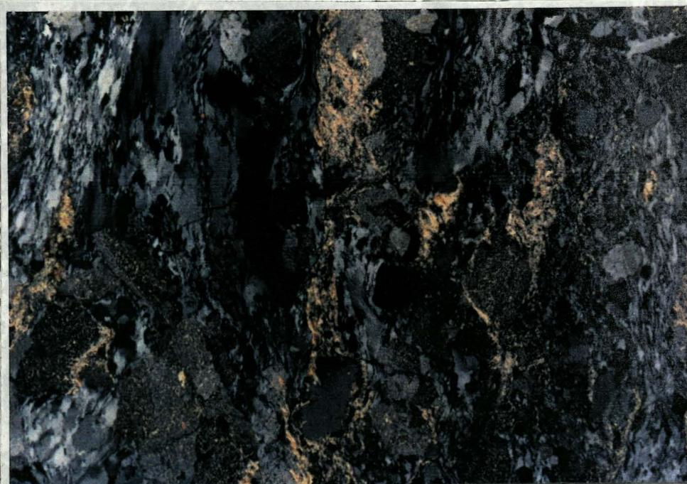
Abb.36: Granodiorit - Typ 4: Die Probe C2/B-1 stammt aus einem kleinen ehemaligen Steinbruch 150 m NW der Kote 312 (Kirchenberg bei Wartberg); Bildausschnitt: 9,8 x 6,7 mm.
